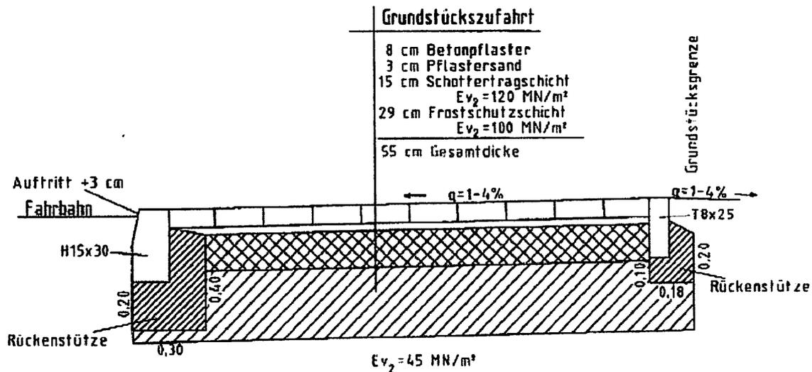
**Bild 6-1: Grundstückszufahrt - Regelquerschnitt**
