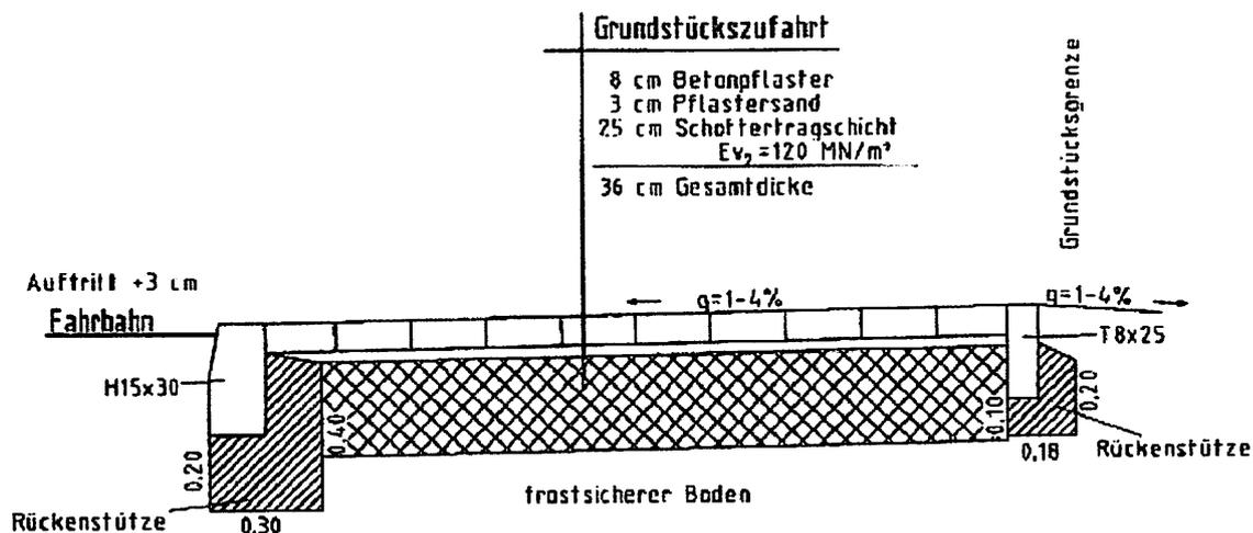
**Bild 6-2: Grundstückszufahrt - Regelquerschnitt**
