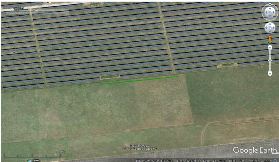
**Abbildung 3-11: Ausschnitt Eingriffsfläche mit dem geplanten Sandwall (grün) etwa nach dem Schema aus Abbildung 3-10, Luftbildbasis © 2009 GeoBasis DE/BKG © 2018 Google earth**
